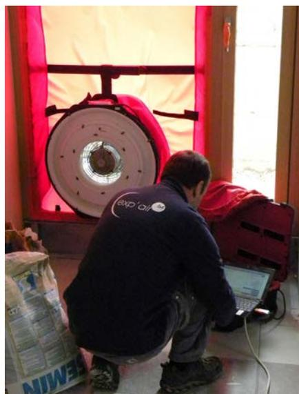
Ce 1<sup>er</sup> test, réalisé avant finition, permet de détecter les fuites d'air du bâtiment et d'en mesurer l'importance. Il est important car il permet de vérifier que les différents corps de métiers ont bien travaillé les uns avec les autres, ce qui garantit une bonne isolation globale du bâtiment. Des correctifs peuvent encore être apportés avant les finitions et un dernier test qui sera effectué avant réception du chantier.
